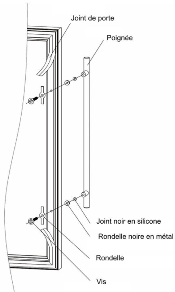
2. Mettez en place et insérez les différents éléments en suivant le schéma ci-dessous :
