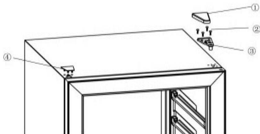
3. Retire la puerta del armario abriéndola ligeramente y levantándola
