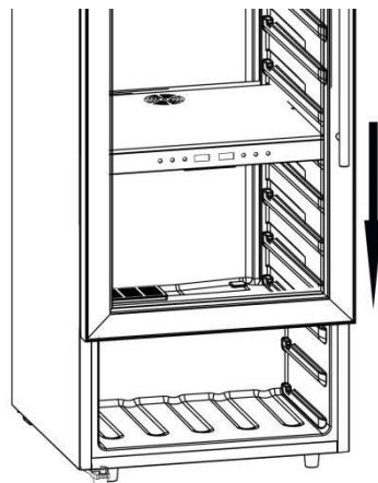
7. Spostare la parte superiore della cerniera a sinistra e coprire il foro della cerniera destra con il pad nero
