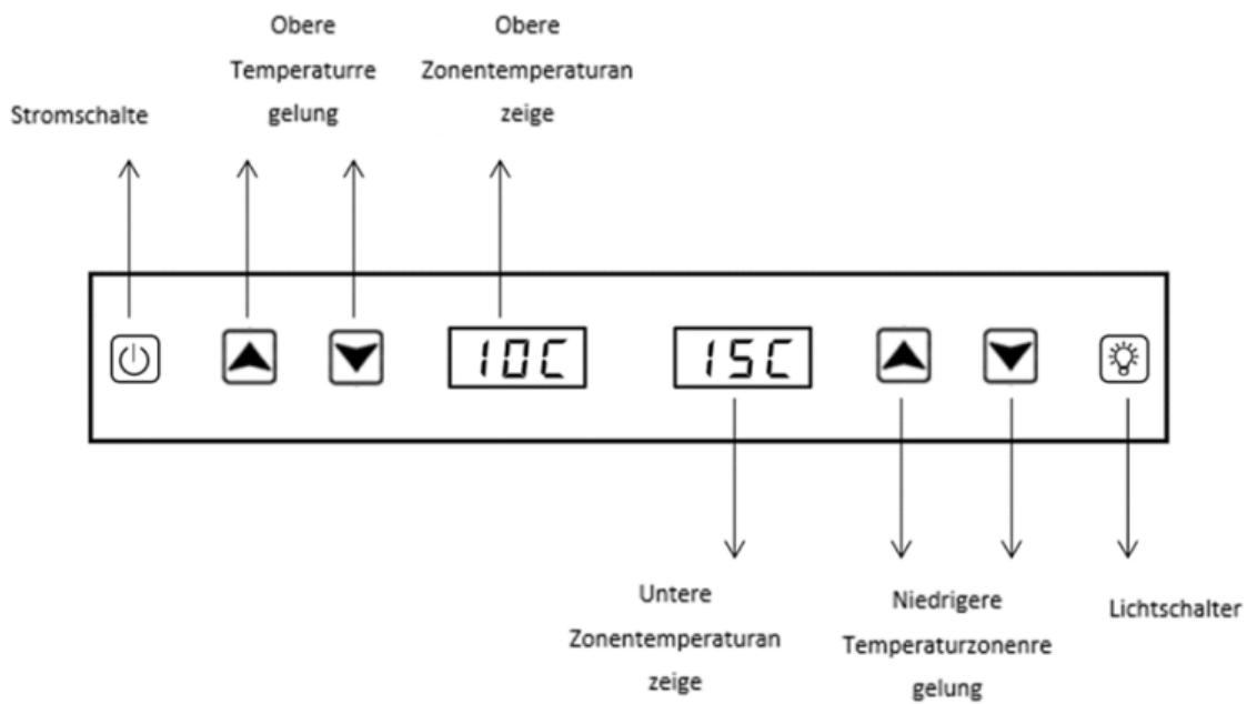
Dieses Gerät verfügt über zwei Zonen.
