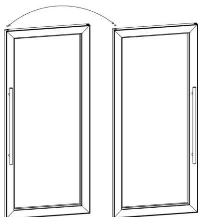
6. Soulevez légèrement la porte, la déplacer vers le bas jusqu'à ajustement dans le pivot de la porte sur la charnière inférieure.
