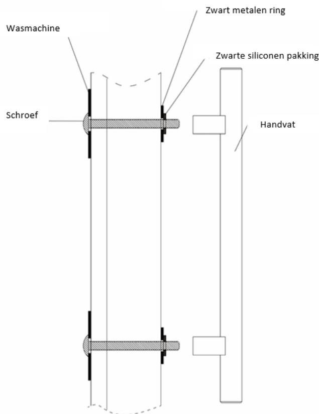
3. Lijn de handgreep uit met de schroeven en draai deze vast totdat de handgreep recht is en parallel aan het oppervlak van de deur wordt gehouden. NIET TE HARD DRAAIEN om de montage en het glazen oppervlak van de deur niet te beschadigen.
