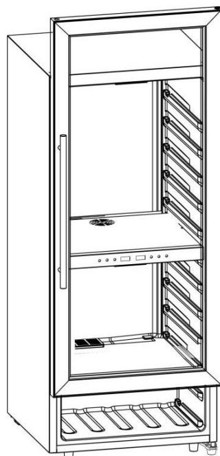
8. Entfernen Sie die unteren Scharnierteile auf der rechten Seite und installieren Sie sie dann auf der linken Seite
