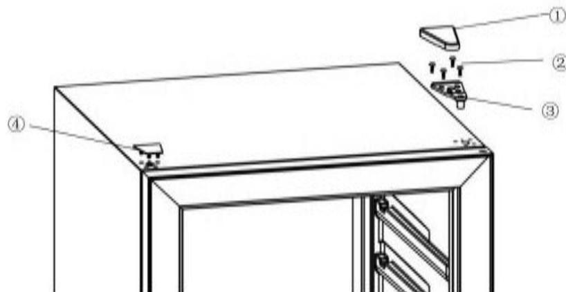
3. Verwijder de deur van de kast door deze iets te openen en op te tillen
