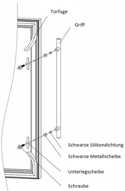
2. Positionieren Sie die verschiedenen Elemente und fügen Sie sie gemäß der folgenden Abbildung ein:
