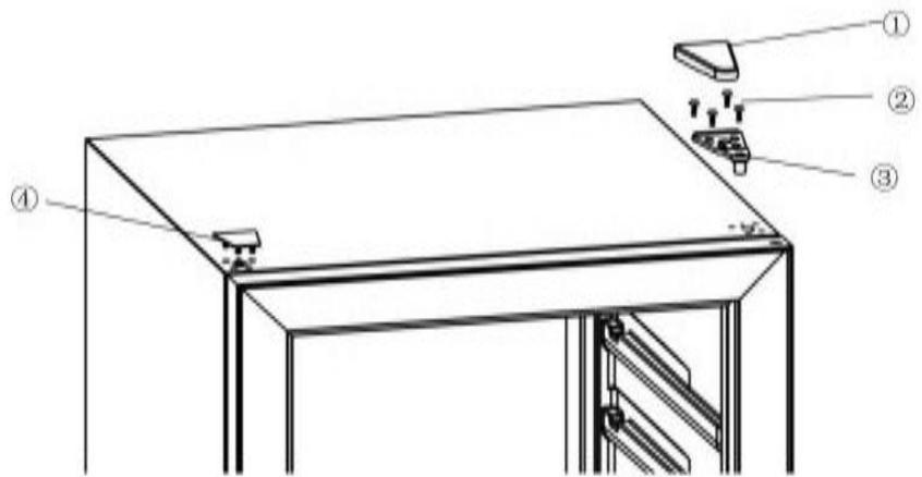
7. Entfernen Sie die Tür vom Schrank, indem Sie sie leicht öffnen und hochheben
