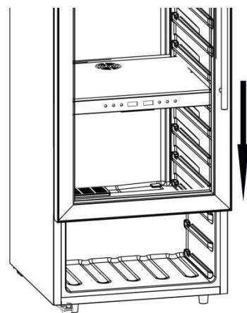
7. Repositionner la partie supérieure de la charnière à gauche, et remettre le cache à droite.
