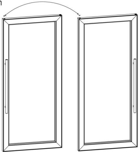
10. Heben Sie die Tür leicht an und bewegen Sie sie nach unten, um sie in den Türstift am unteren Scharnier einzuführen.
