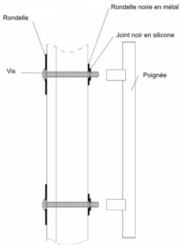
3. Alignez la poignée sur les vis et vissez jusqu'à ce que la poignée soit droite et maintenue parallèlement à la surface de la porte. NE PAS SERRER TROP FORT afin de ne pas endommager l'assemblage et la surface vitrée de la porte.
