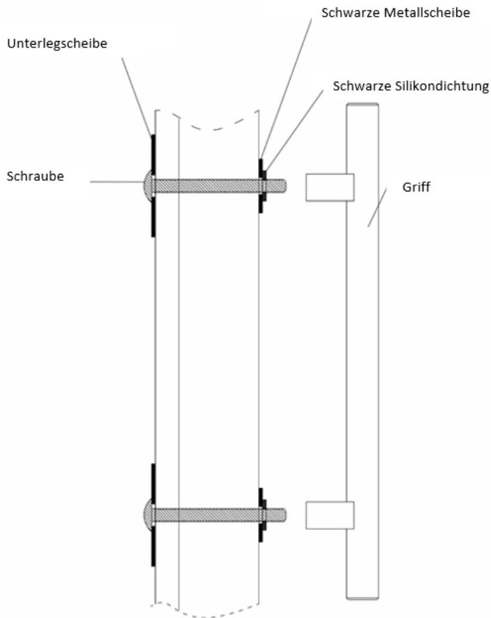
5. Richten Sie den Griff an den Schrauben aus und ziehen Sie ihn fest, bis der Griff gerade ist und parallel zur Oberfläche der Tür gehalten wird. NICHT ZU SCHWER ANZIEHEN, um die Baugruppe und die Glasoberfläche der Tür nicht zu beschädigen.
