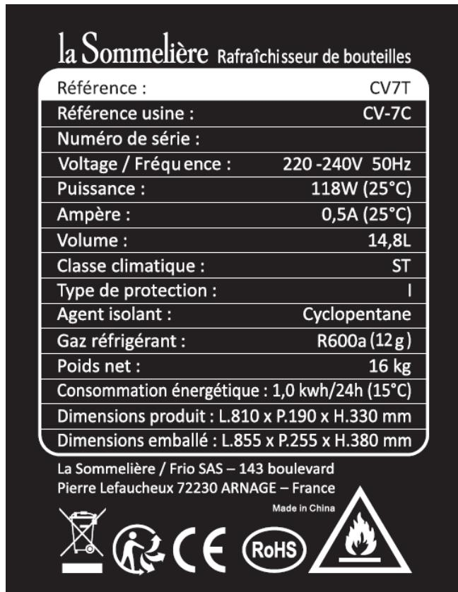
La placa de identificación en el lado derecho de su dispositivo tiene toda la información específica de su dispositivo.
