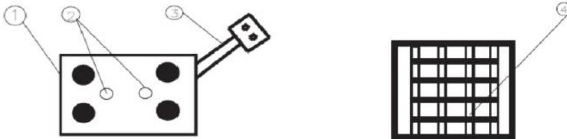
① Support de la lampe    ② Vis de maintien    ③ Câble    ④ Cache de la lampe
