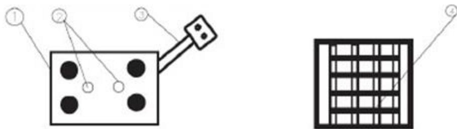
① Lamphouder    ② Bevestigingsschroef    ③ Kabel    ④ Lampkap
